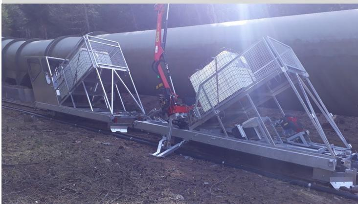
Palfinger PK 2900 con telecomando o controllabile direttamente dal veicolo. L'azionamento avviene tramite un motore a benzina Honda GX630 montato sul veicolo, con albero motore orizzontale, che aziona una pompa idraulica.
