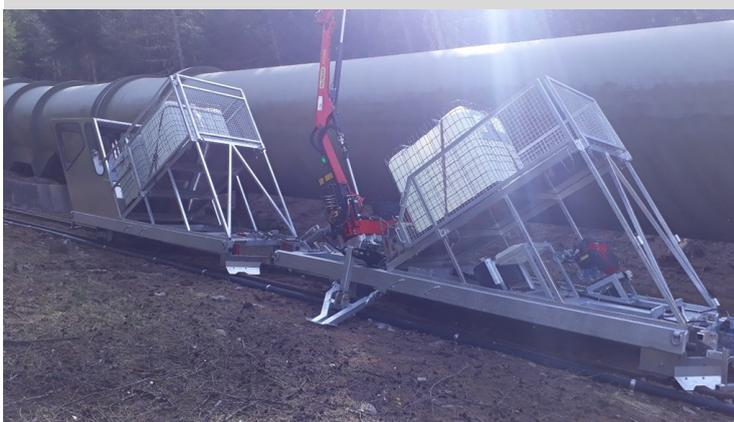
Palfinger PK 2900 mit Funkfernsteuerung oder ab Wagen bedienbar. Der Antrieb erfolgt durch ein auf dem Wagen montierter Honda GX630 Benzinmotor mit horizontaler Kurbelwelle, welcher eine Hydraulikpumpe antreibt.
