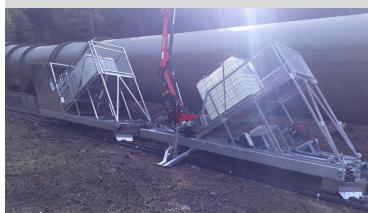
Palfinger PK 2900 mit Funkfernsteuerung oder ab Wagen bedienbar. Der Antrieb erfolgt durch einen auf dem Wagen montierten Honda GX630 Benzinmotor mit horizontaler Kurbelwelle, welcher eine Hydraulikpumpe antreibt.
