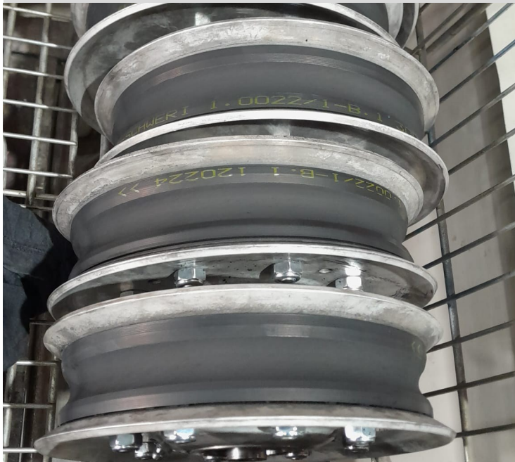
Revidierte Laufwerkrollen mit neuen Einlagerungen
