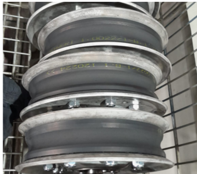
Galets de roulement révisés avec nouvelles bagues d'insertion
