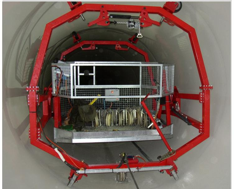
Neubau eines Schachtwagens für das Befahren eines Schräg- und Vertikalschachtes der Anlage Cleuson-Dixence im Wallis. Die Plattform ist hydraulisch neigbar und mit einer Lenkvorrichtung ausgestattet. Der Vertikalschacht hat eine Länge von rund 70 Metern.
