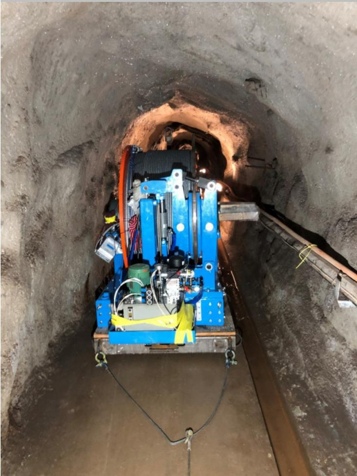
Dank steckbarem Aufbau der Winde konnte die Antriebschwinge getrennt von Windentrommel und Bremshydraulik transportiert werden.
