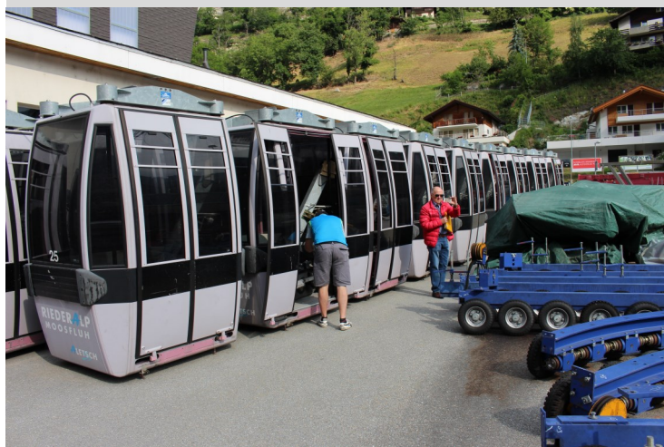
Demontage Kabine mit Gehänge und Laufwerk der LSB Seebodenalp
